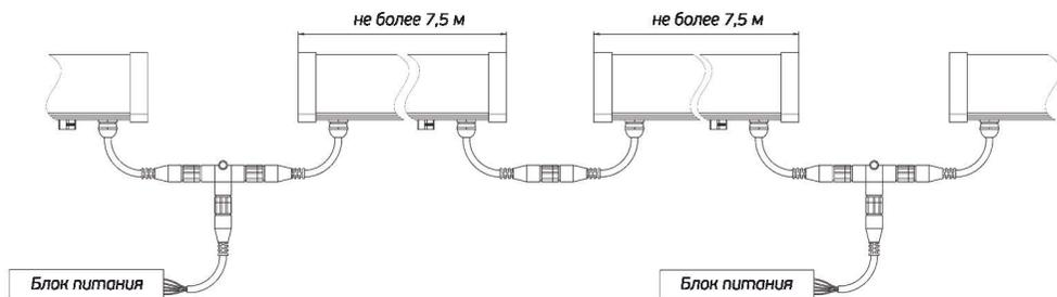
Подключение неуправляемых светильников в линию не более 30 м.
