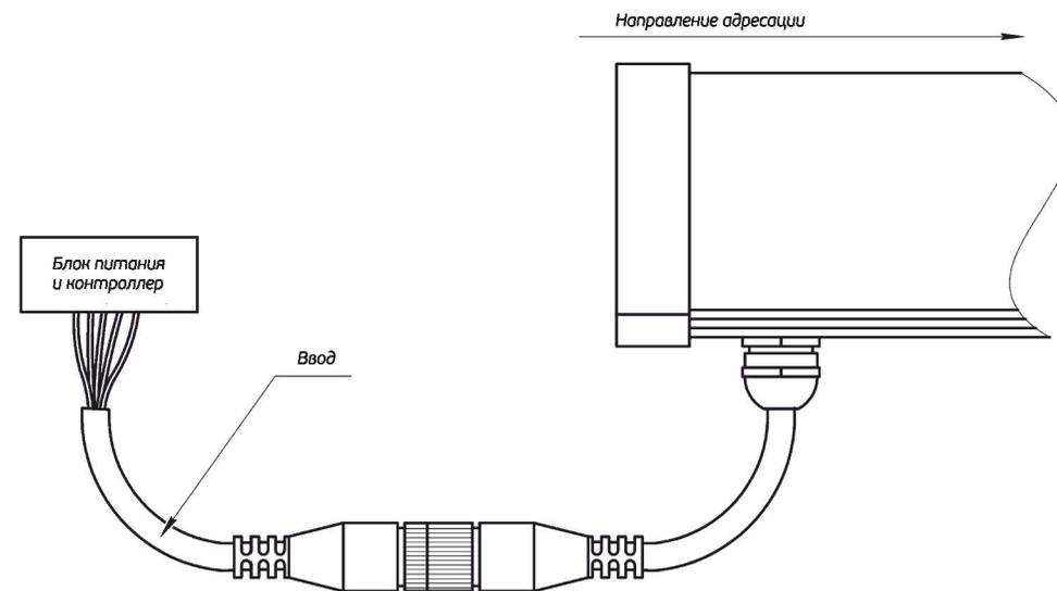
При общей длине светильников более 7,5 м необходимо подключать блок питания в разрыв между светильниками применяя тройник.
