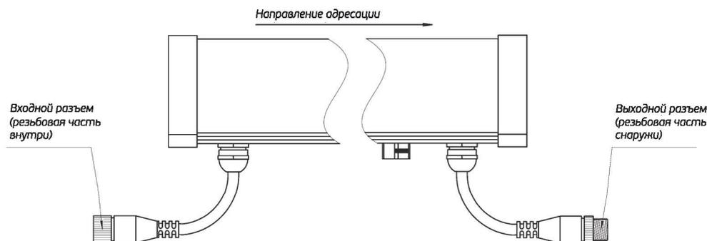
При необходимости светильники можно подключать последовательно, при этом остается возможность автоматического назначения адресов.
