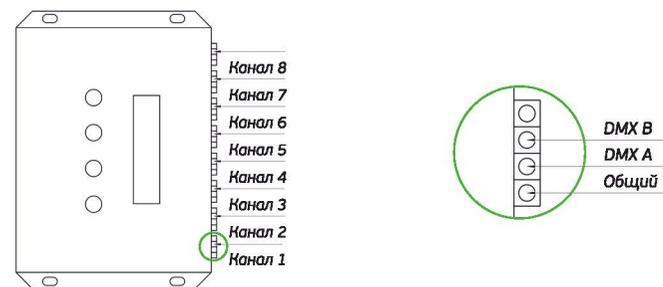
Стоит обратить внимание, что контакт Pin (назначение адреса) не подключается к контроллеру. Применение контроллера K8000-C позволяет подключать до 144 м светильников L-contour. Таким образом подключение светильников при общей длине светильников:
